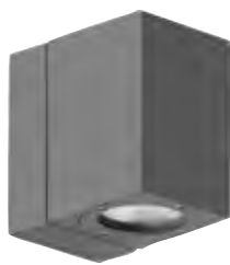
3279614. Strukturgraphit, IP54, 230 V, 7 W LED, 3000 K, 460 lm, H 140, B 70, L 100 € 229,50
