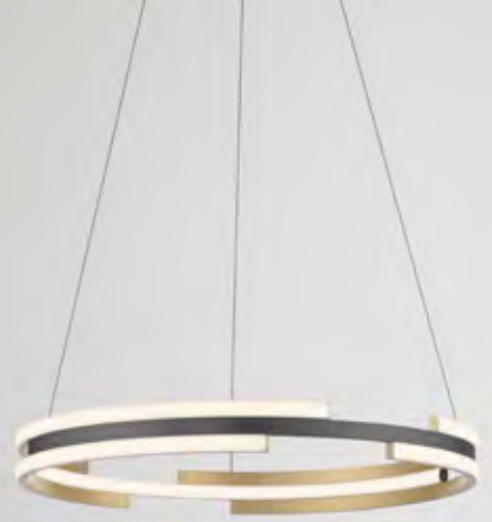
2630563. Messing matt, inkl. Infrarot- Fernbedienung, 55 W LED, 2700-5000 K, 6900 lm, D 600, Abh. 600-1200 € 379,00
