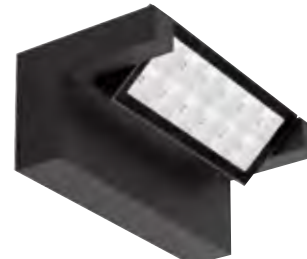
3269573. Anthrazit, IP65, Kopf schwenkbar, 200-240 V, 10 W LED, 3000 K, 1000 lm, H 80, L 107, B 204 € 154,60
